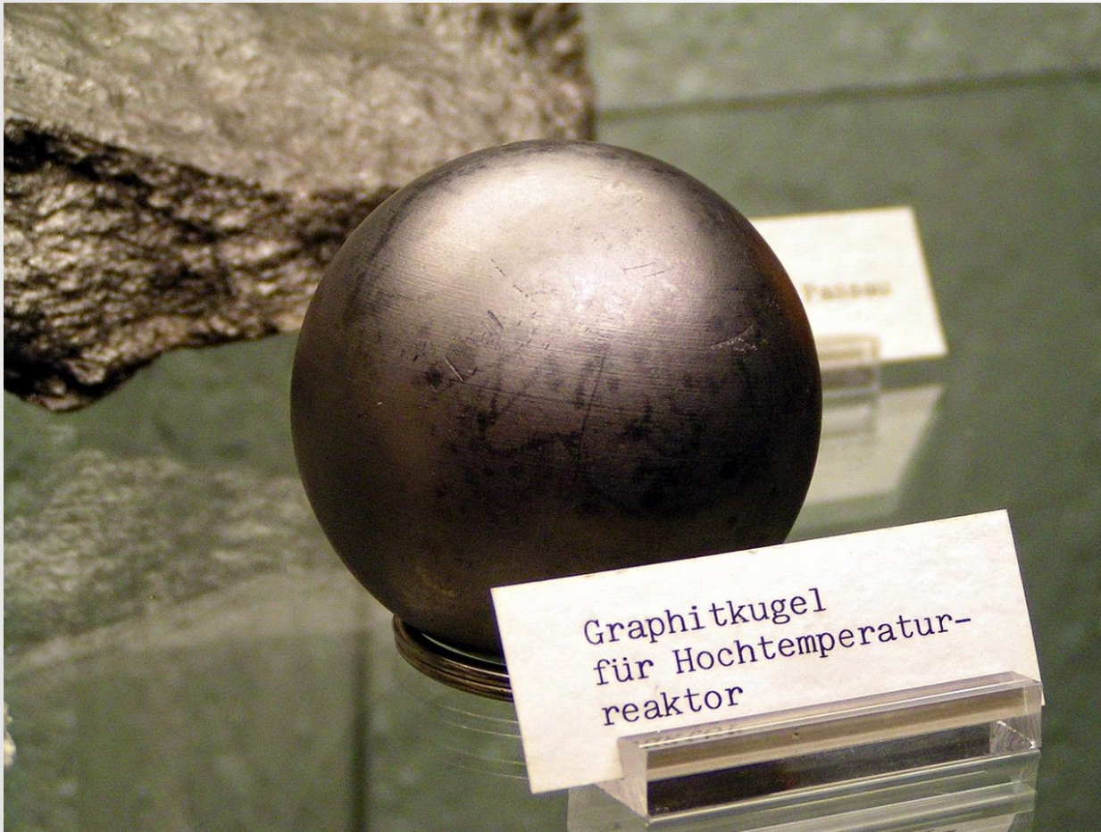
Beschichtetes Brennstoff- teilchen, Durchmesser ca. 0,9 mm. 10 - 40 Tsd. Teilchen/Kugel
